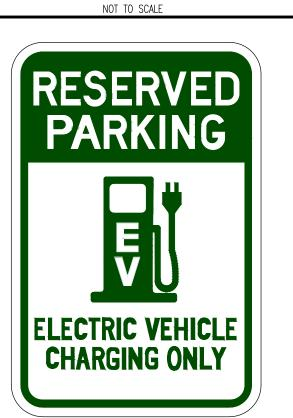
1. TOTAL HEIGHT OF THE ELECTRIC VEHICLE CHARGING SPOT SIGN SHALL BE NO MORE THAN 7 FEET FROM GRADE.
